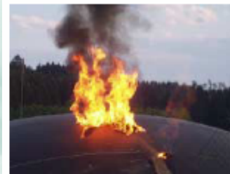
Bild 10 + 11: 6. Brandversuch ein brennender benzingetränkter Lappen wird auf den Foliengasspeicher geworfen
